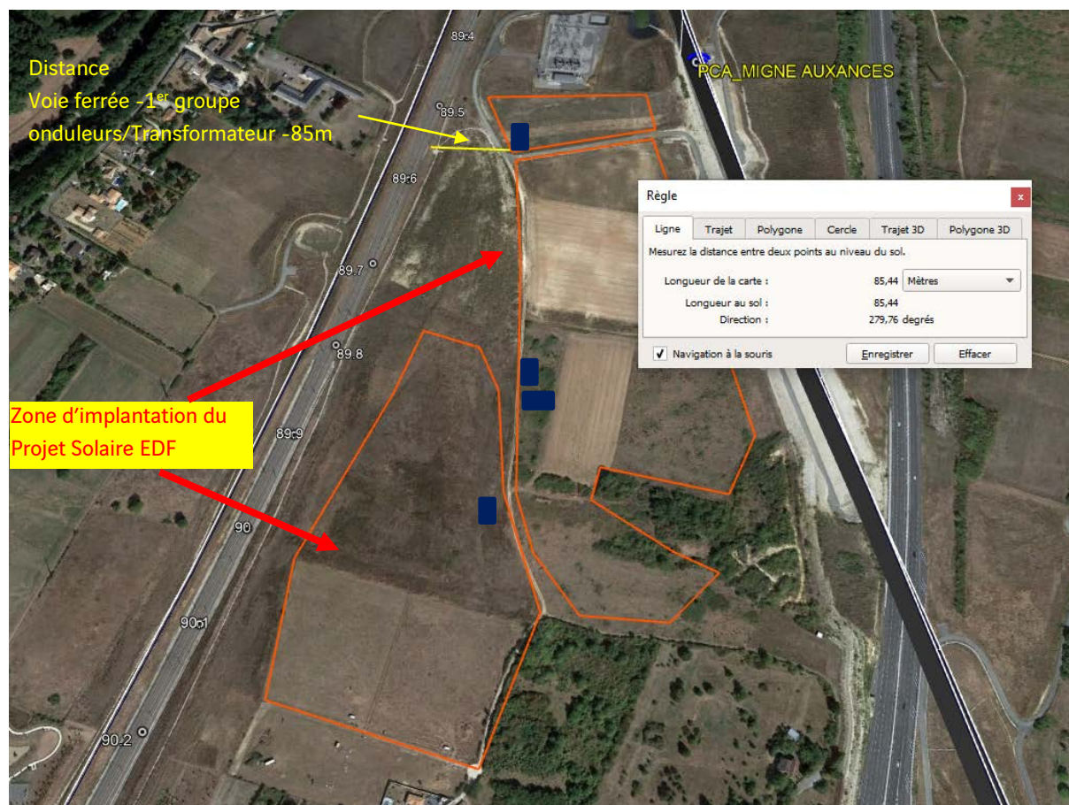
Figure 9 – Distance Voie Ferrée LGV 566000 vs 1 er Onduleur Migné-Auxances
